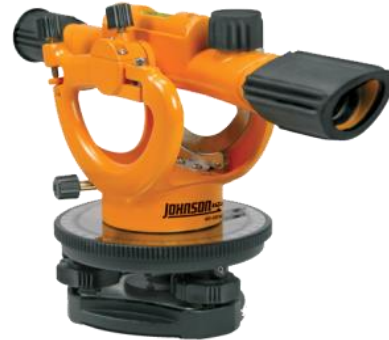
Figure 4-6 Niveau théodolite de l'arpenteur
